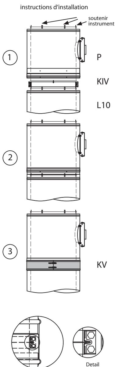
Il est possible de laisser dépasser le conduit de la toiture de 3 m/2,5 m/1,0 m à compter du dernier point de fixation. Au delà il faudra placer un haubannage (SA).
