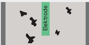
1. Feinstaubpartikel strömen mit dem Abgas durch den Abgaskanal
