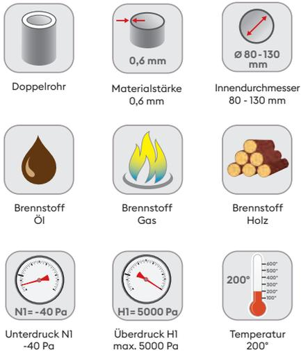
Das konzentrische Doppelrohrsystem **complex E DR** dient der Ableitung von Abgasen aus Wärmezeugern, die mit Öl oder Gas betrieben werden. Zusätzlich wird über den Ringspalt zwischen Außen- und innenrohr frische Zuluft für den Wärmezeuger zugeführt.
